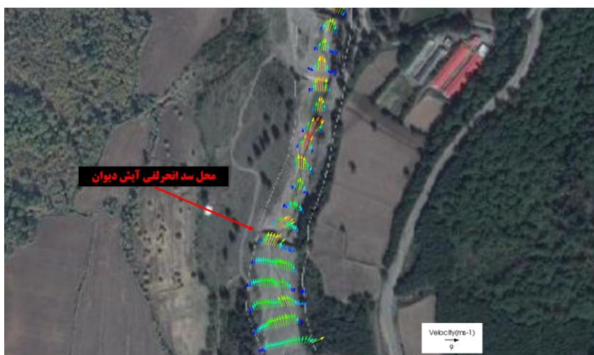
شکل ۹: بردارهای سرعت جریان در رودخانه ی قره چای در دبی ۱۰۰ ساله
